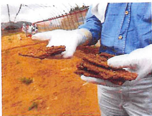
図 3 天然ポリオンコンプレックスで固定化し剥離された土壌片
