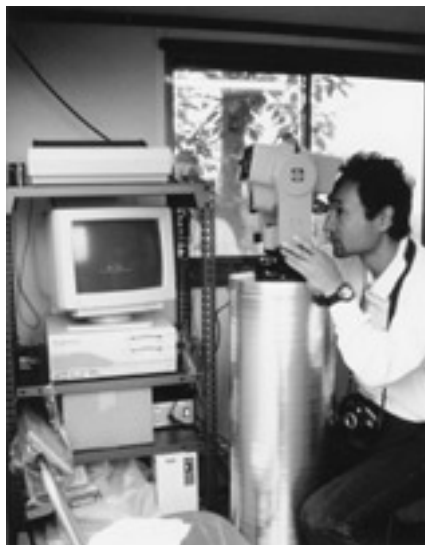
写真8 眉山観測のための自動連続光波測距システム。左の棚に、システム制御のためのパソコンが設置されています。1991年5月11日撮影。
