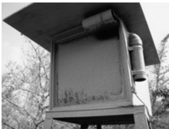
写真10 屋根をつけた自動連続光波測距システム。雲仙、野岳山頂。屋根をつけても、火山灰は垂直なガラスの表面に付いてしまいました。しかも、この後、都合の悪いことに、降水で洗い流されることがありませんでした。1992年6月19日撮影。
