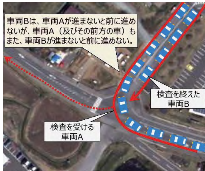
図 22 グリッドロック現象 いわゆる「にらみ合い」でいずれの方向にも動けなくなる。
