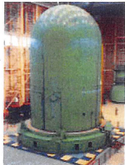
大型振動台による耐震試験
