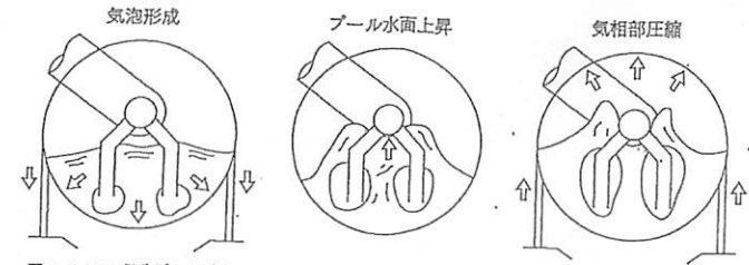
図9-LOCA発生時に圧力抑制室内で生じるプール・スウェル現象
