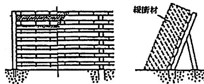
図9-21 落石防護柵の種類 (H鋼式) (新斜面崩壊p282)
