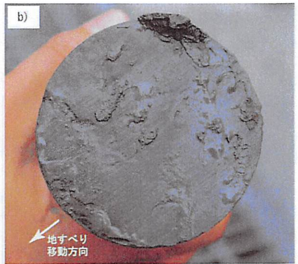
写真-2 すべり面表面にみられる擦痕
