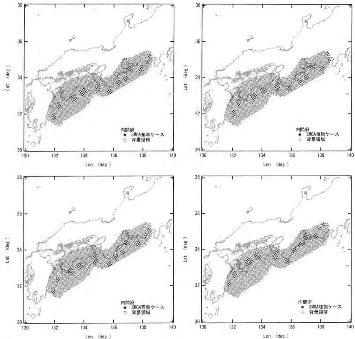
図-5 南海トラフの巨大地震モデル検討会<sup>1)</sup>における SMGA の配置
