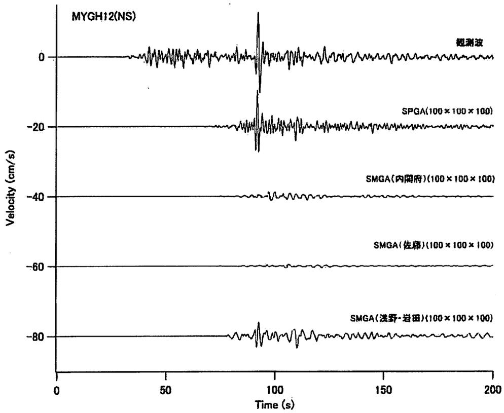
図-A.1 SPGA モデルと SMGA モデルによる速度波形の計算結果と観測結果との比較 (分割数 100×100×100)
