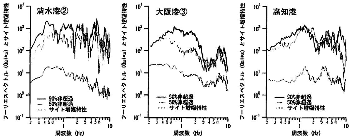
図-12 工学的基盤における加速度フーリエスペクトルの計算結果の例（サイト増幅特性との比較）
