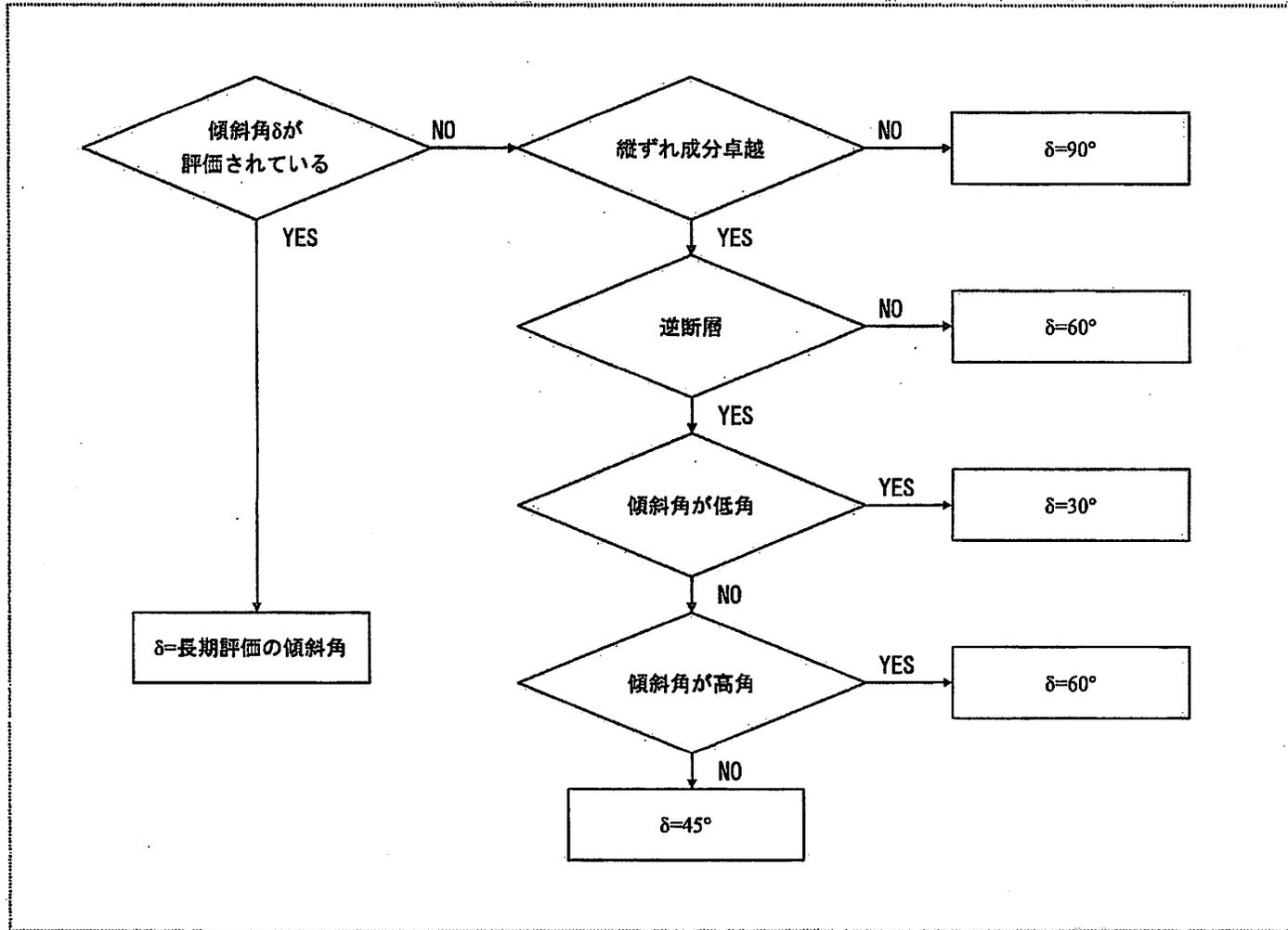
付図4 活断層で発生する地震の震源断層モデルの傾斜角設定の流れ
