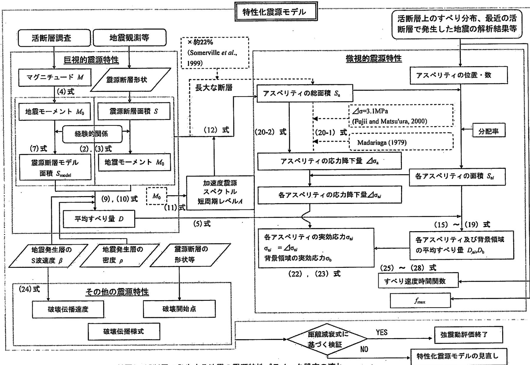
付図2 活断層で発生する地震の震源特性パラメータ設定の流れ
