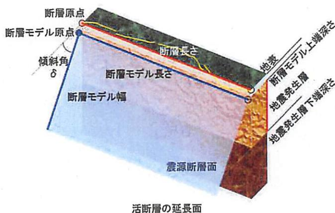
断層モデル長さ、幅、深さ、傾斜角
