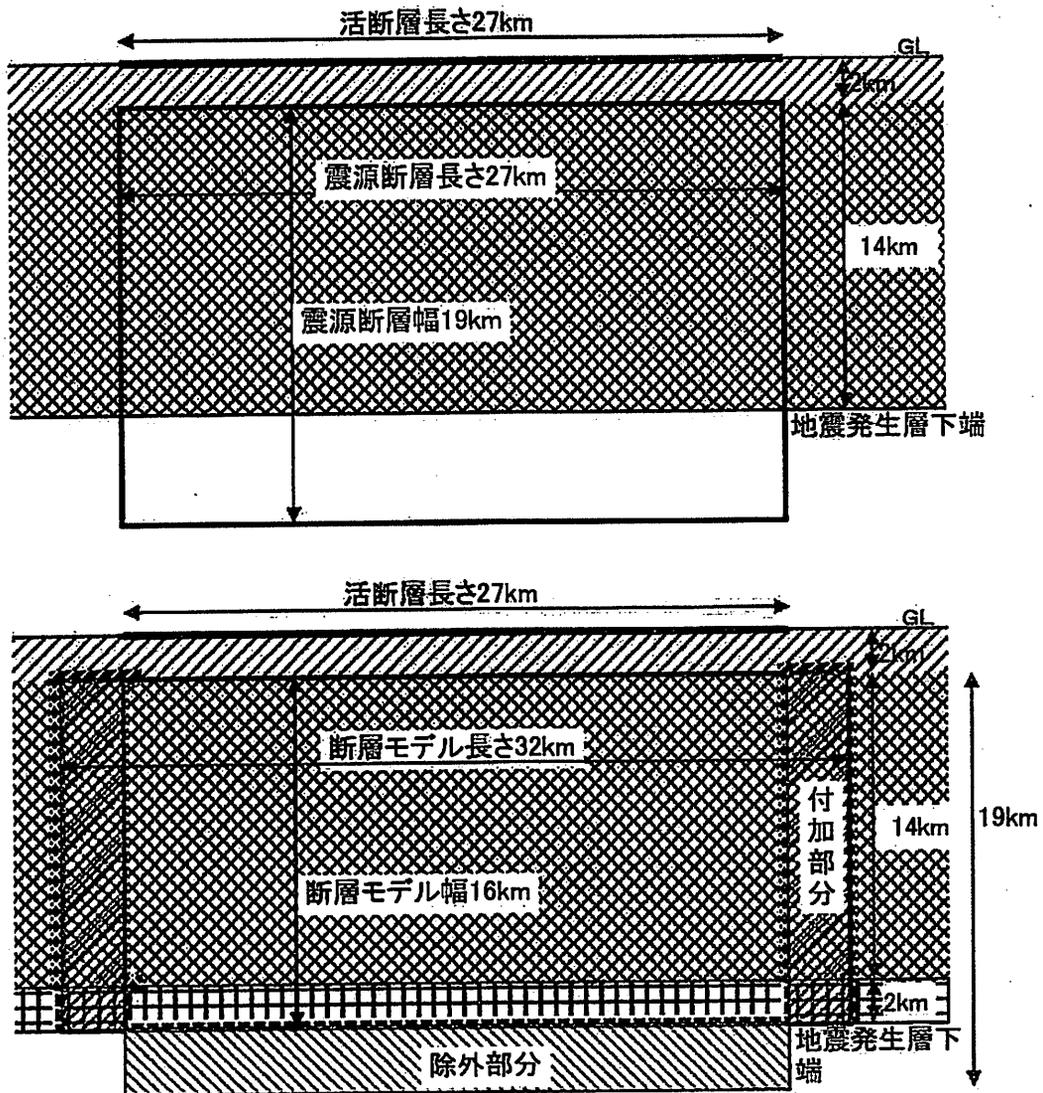
断層モデル長さおよび幅の概念図
