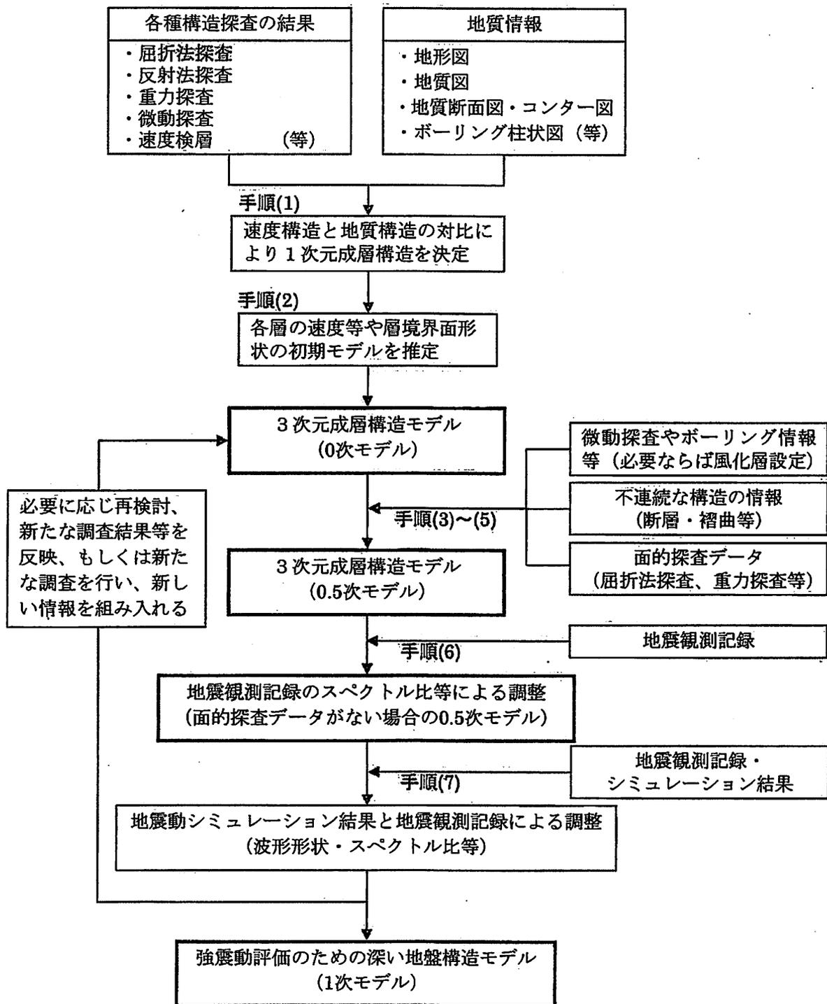
付図6 強震動評価のための深い地盤構造モデル作成の流れ
