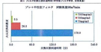
図6 フィルタ交換目詰到達時間(プレ+中性能フィルタ2段、定積風量)
