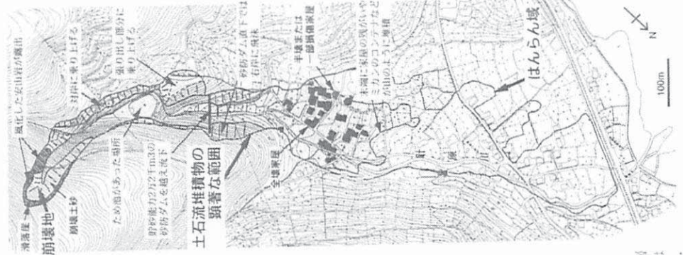
図8.7 出水市土石流災害の概要図(中澤,1997) 1997年7月10日、鹿見島県出水市で、亀裂の多い深層風化を被った安山岩の斜面が崩壊した。崩壊した土砂は土石流へ移行し、下流の集落に大きな被害をもたらした。
