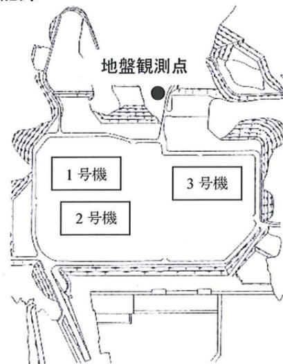
図-2 敷地地盤の地震計設置位置図
